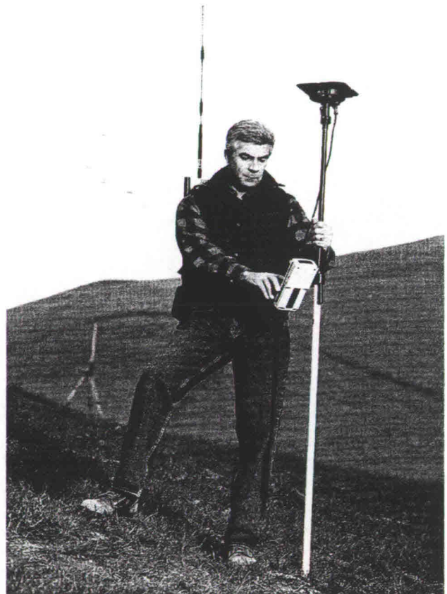
4.31 Landmeetkundige survey met DGPS
