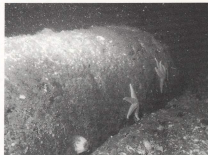
Opname van een verloren chloorgascontainer op de zeebodem. Gezien de aard van de lading was opsporing en berging van de containers noodzaak. Eén voor één werden ze met behulp van side scan sonar gelocaliseerd. De foto werd gemaakt door een vanaf het meetvaartuig bestuurde ROV (Remote Operated Vehicle). Deze ROV's zijn uitgerust met camera's en bestuurbare grijper-armen. Ze worden gebruikt voor inspectiewerk onder water, onder andere van pijpleidingen. Foto Meetdienst Noordzee
